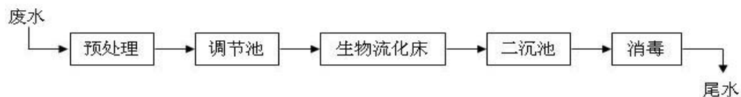
图6 小纪镇玉澄污水处理厂处理工艺流程图
